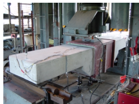
図 - 18 新型 PCF 壁高欄の曲げ試験の状況
