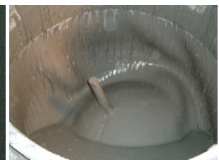
図 - 4 ビニロン繊維 図 - 5 練り混ぜの様子
