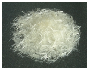
図 - 4 ビニロン繊維 図 - 5 練り混ぜの様子
