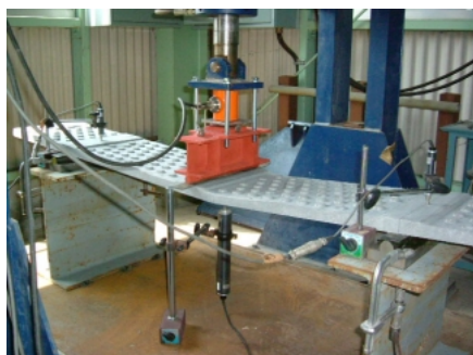
図 - 12 PCF 版曲げ試験の様子 (正曲げ方向)
