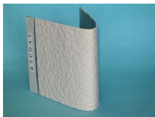
R・T COAT塗布後折曲げ状況
