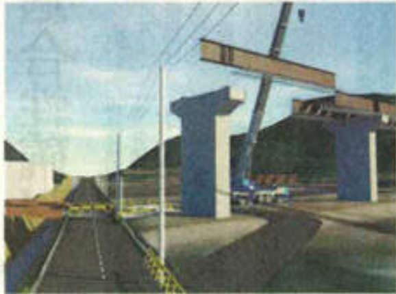
CIMを活用した橋梁架設時の可視化
